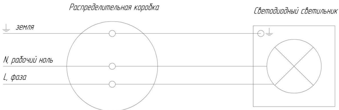
Рисунок 4а - Схема подключения светильника к сети
