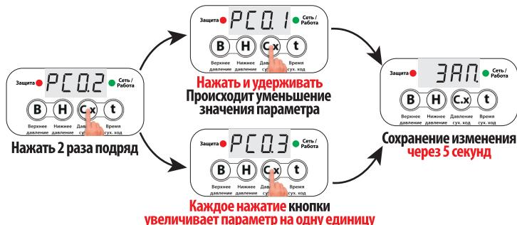
20.4 "tXXX" – задержка срабатывания защиты от "сухого хода" в секундах. Если во время работы насоса давление в системе водоснабжения не поднимается выше уровня "PCX.X" до истечения времени "XXX", то РДЭ отключит насос по функции защиты от сухого хода.
