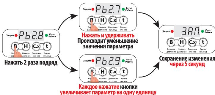
20.2 "РХХ.X" – нижнее давление. Давление включения насоса. Насос включится после снижения давления до уровня "РХХ.X" с задержкой одна секунда.
