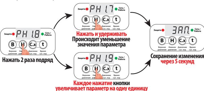
20.3 "PCX.X" – давление "сухого хода". РДЭ выключит насос с целью защиты его от "сухого хода", если давление в системе будет находиться ниже уровня "PCX.X" в течение времени, установленного параметром "tXXX" (п. 20.4, стр. 12).
