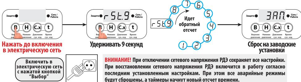
**ВНИМАНИЕ!** При отключении сетевого напряжения РДЭ сохраняет все настройки. При восстановлении сетевого напряжения РДЭ включится в работу согласно последним установленным настройкам. При этом все аварийные режимы будут сброшены, а таймеры начнут новый отсчет времени.
