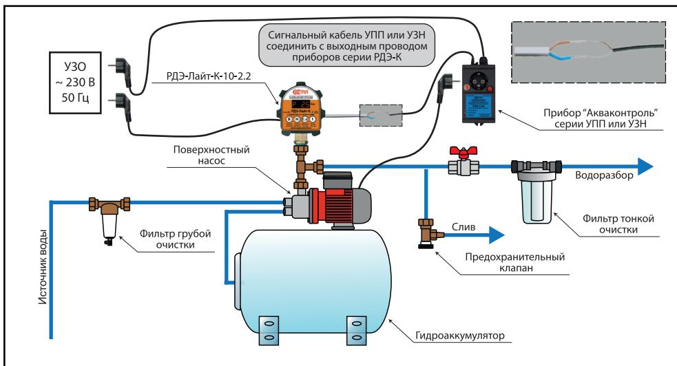
16. Электрическая схема подключения насоса
