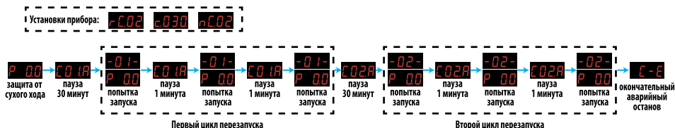
Графическое представление работы режима перезапуска “rC.02”
