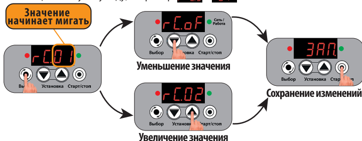
Графическое представление работы режима перезапуска “rC.02”
