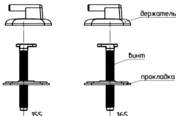
рис.4 Варианты установки сиденья унитаза с металлическим креплением
