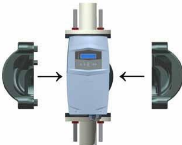
Рисунок 6.6 Установка теплоизоляционных крышек
