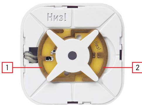
Замыкание контактов 1 и 2 для прописки датчиков
