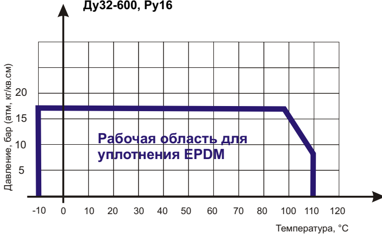
Диаграмма Давление / Температура для затвора поворотного дискового ABRA-BUV-VF826Dxxx и ABRA-BUV-VF866D Ду32-600, Ру16
