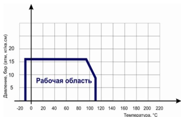
Диаграмма определяет рабочую область для фильтра сетчатого латунного резьбового в координатах Давление (в барах приборного) / Температура (° С).
