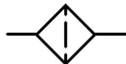
Основные области применения таких фильтров - механическая очистка рабочей среды от грязи, ржавчины, стружки и т.д. в системах отопления, тепло-водоснабжения и системах кондиционирования. Также данную конструкцию можно использовать на воздух, азот, масла, углекислый газ и другие нейтральные жидкости и газы.
