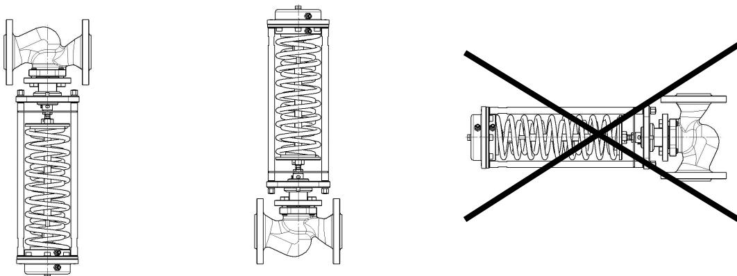
Рисунок А.3-Монтажные положения регулятора на трубопроводе при температуре среды до 100 °C (Прямолинейные участки до и после регулятора не требуются)
