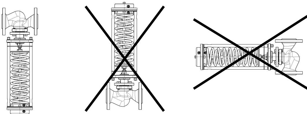
Рисунок А.4-Монтажные положения регулятора на трубопроводе при температуре среды выше 100 °C (Прямолинейные участки до и после регулятора не требуются)
