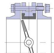
–Отцентрируйте поворотный затвор и слегка закрутите болты (шпильки), но не затягивайте их. Проверьте свободный ход диска.
