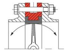
–Перед началом монтажа важно убедиться, что внутренний диаметр фланцев соответствует номинальному диаметру дискового поворотного затвора
