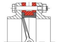
–В случае использования фланцев с внутренним диаметром больше чем номинальный диаметр затвора, фланцы не будут полностью закрывать седловое уплотнение, что может привести к повреждению и деформации седлового уплотнения.
