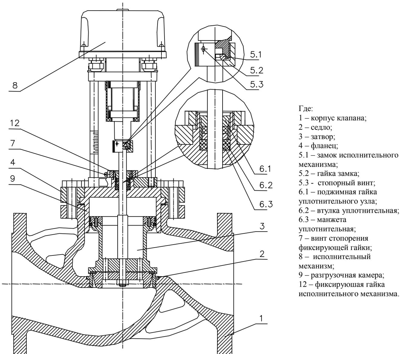
Рисунок 1 Общее устройство клапана K3Pp-100/95.Б-XX
